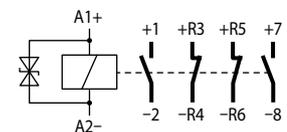
Beispiel: Polaritätsrichtige Reihenschaltung aller Hauptkontakte zur Erhöhung der Bemessungsbetriebsspannung  $U_{ov}$  s. a. Tabelle «Technische Daten».
